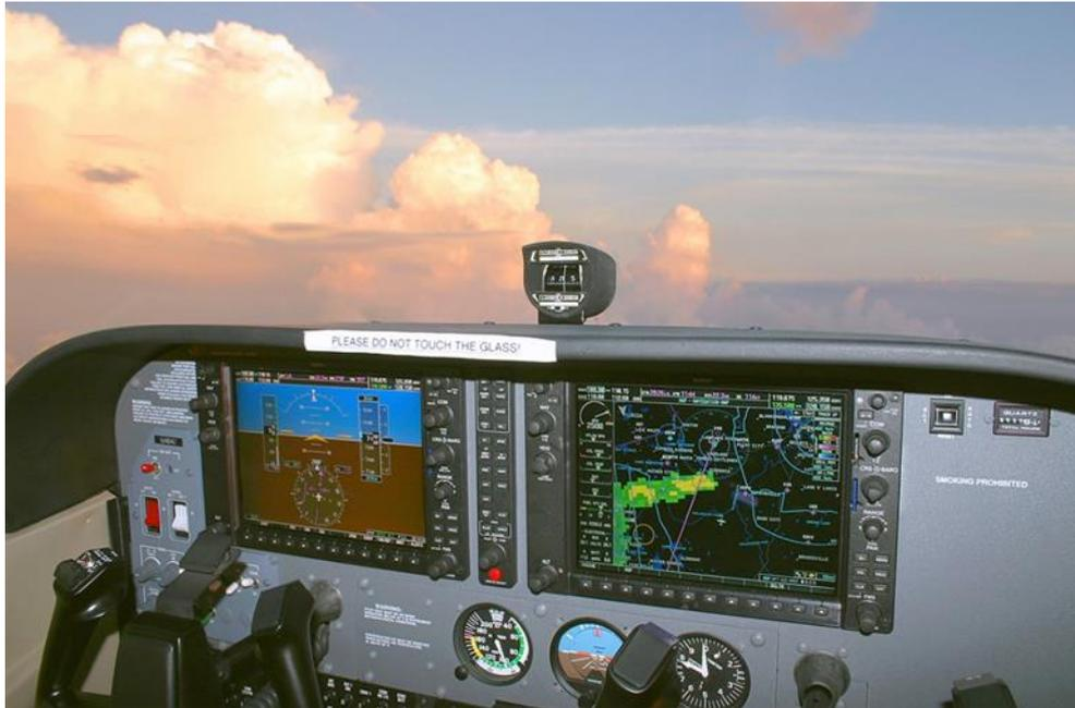
*Figura 22.* Cabina interior del Cessna C-172 Skyhawk Glass Cockpit. Tomado de la página web *Airliners* especializada en especificaciones de aeronaves, 2016. Recuperado de <https://www.airliners.com>
