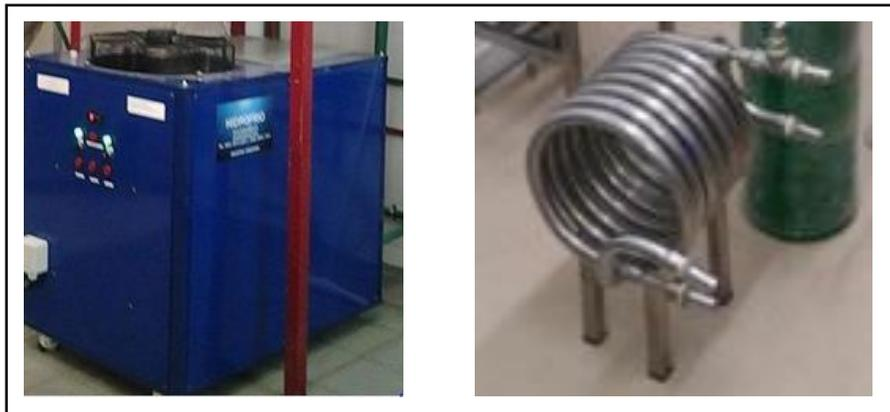
*Figura 54.* Equipo de enfriamiento, se usa en el proceso rápido que se quiere de 100°C a 20°C, para evitar el ingreso de bacterias.
