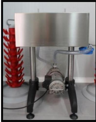
*Figura 53.* Equipo para el lavado de las botellas que serán desinfectadas y posteriormente llenadas.
