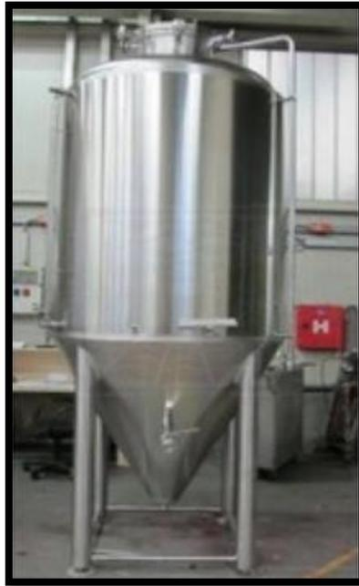
*Figura 50.* Fermentador isobárico de 325 litros, para fermentar la malta.
