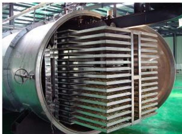
Imagen Maquina liofilizador.
