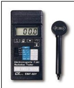
Objetivo: Medir el campo magnetico de las bobinas de todos los motores eléctricos, con la finalidad de detectar su capacidad efectiva
