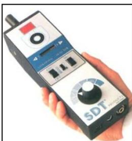
Objetivo: Detectar por ampliación de señal audible la presencia de sonidos anormales en elementos rotativos, percibiendo mediante buena calibración de ruidos internos de fácil interpretación para el personal técnico de mantenimiento.
