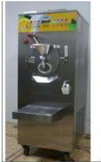
Máquina hecha completamente en acero inoxidable Así 304 que pasteuriza y produce helado artesanal, tiene la capacidad de producción de 15 a 20 litros de helados por hora. El tipo de enfriamiento es por agua.
