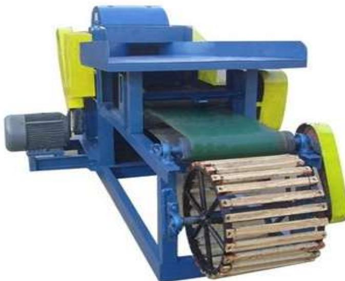
*Figura 17* Máquina decortadora de fibras de pseudotallos de plátano. Adaptado de (Alibaba.com, 2020).
