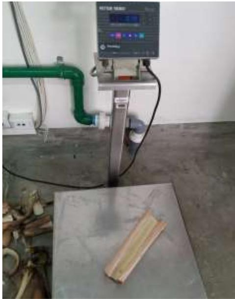
Figura 37 Pesado de capa de pseudotallo en la planta de Pachacamac
