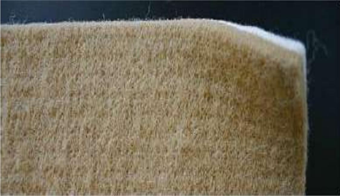
*Figura 5* Obtención de la malla no tejida por la técnica de punzonado. Recuperado de <http://www.directindustry.es/prod/bonar-technical-fabrics/product-24390-821441.html>.
