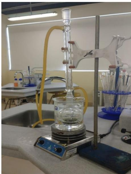
*Figura 15.* Sistema de reflujo para la obtención del extracto
