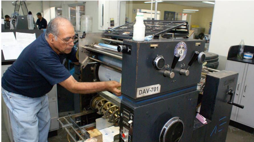
*Figura 18.* Máquina offset en funcionamiento. Proceso de impresión.
