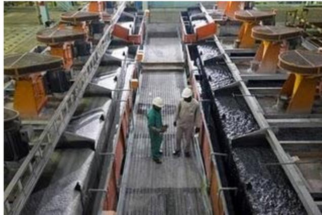
**Figura 17: Celdas de Flotación**
