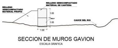
**SECCION DE MUROS GAVION**
