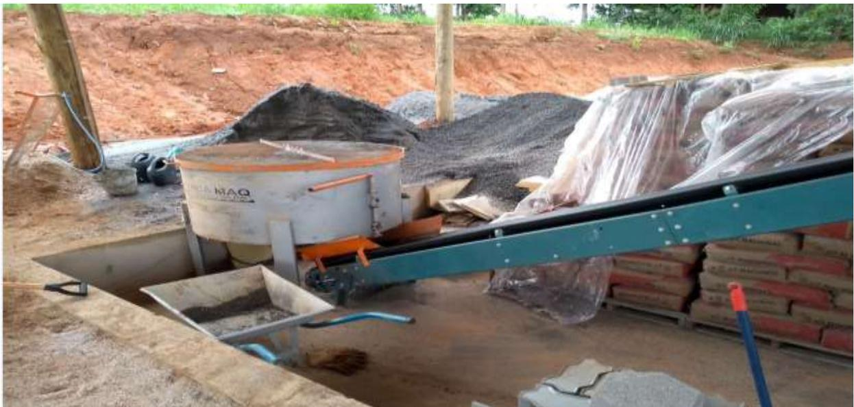
*Figura 55. faja transportadora y mezcladora*
