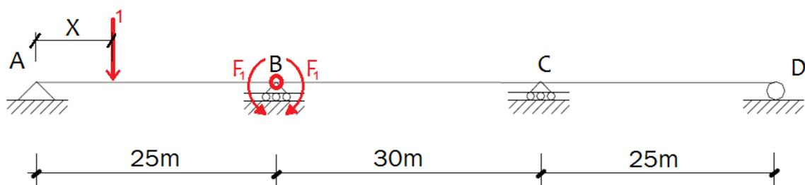
**Figura N° 11.** Viga continua con una rotula instalada en el apoyo B. Elaboración propia.
