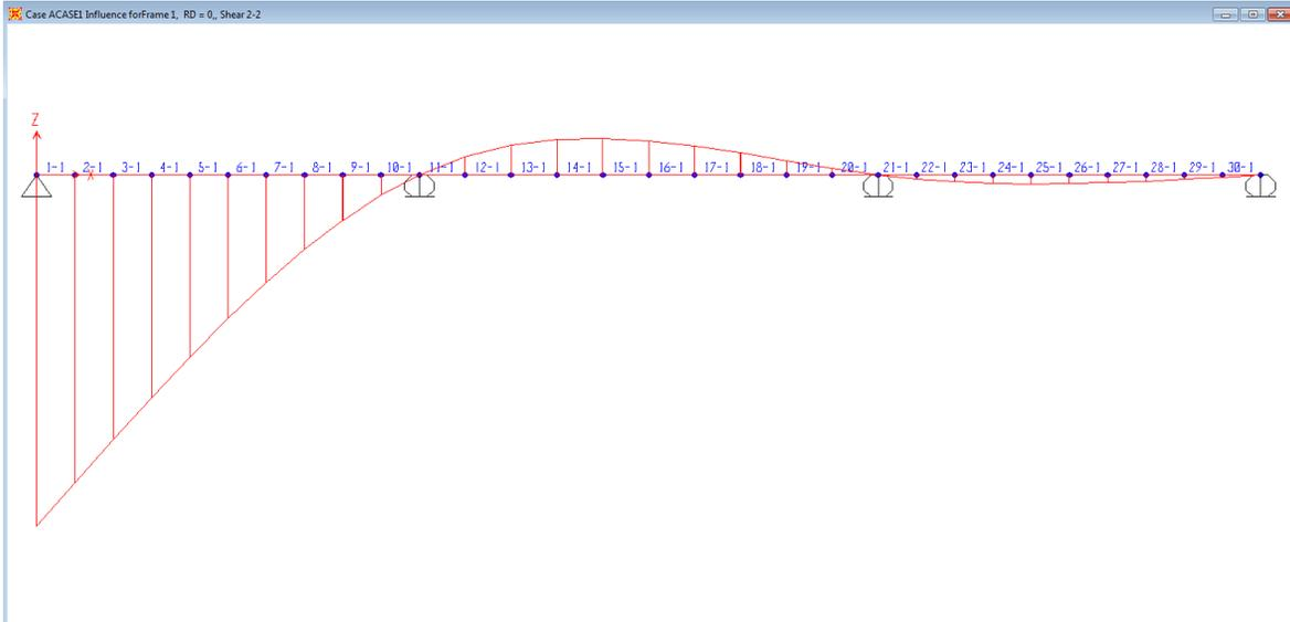
**Figura N° 32.** Líneas de Influencia para la reacción V(100) de la viga continua modelada en SAP2000. Elaboración propia tomada del software SAP2000.
