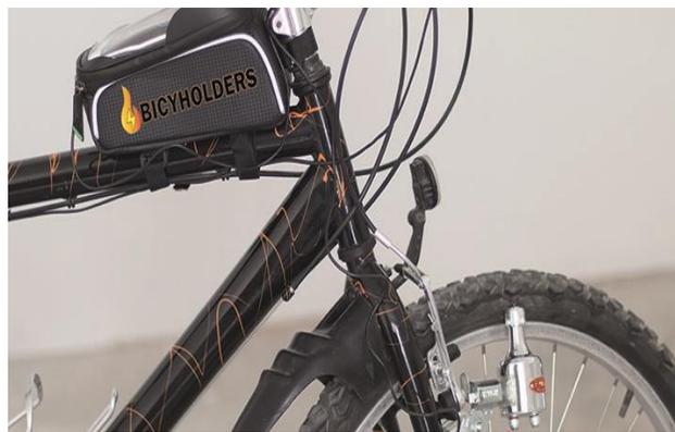
*Figura 42. Estuche porta celular con generador eléctrico.
