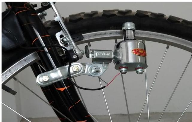
*Figura 41.* El dínamo instalado en la bicicleta.
