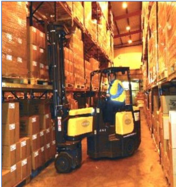
*Figura 11. Montacarga contrabalanceada.*
