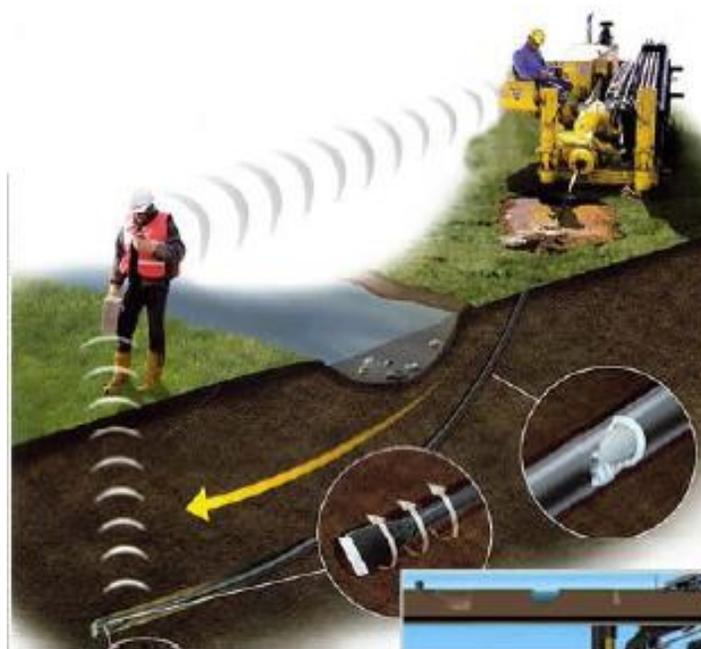
Figura 19. Esquema ilustrativo de sistema de seguimiento de la cabeza de perforación desde la superficie
