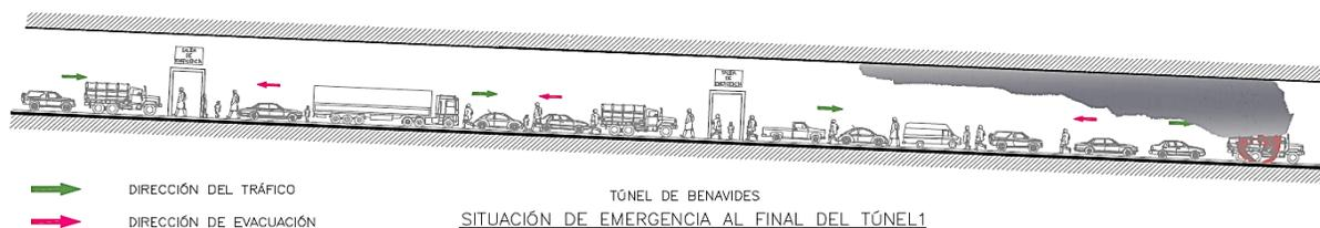
Figura 30. Situación “tipo” de evacuación con fuego en Túnel
