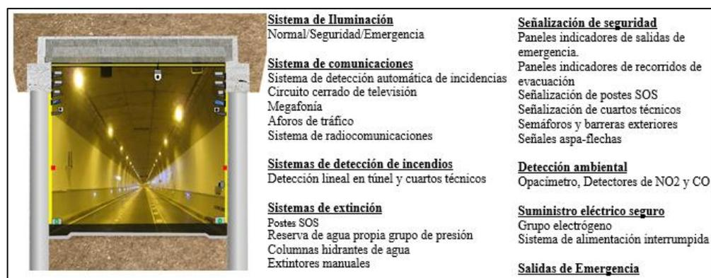
Figura 10. Equipamiento del Túnel
