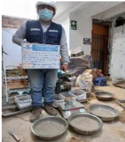
Se prosiguió con el mismo procedimiento de las anteriores calicatas, se utilizaron 4 moldes (4 puntos) 2 puntos secos y 2 puntos húmedos. Para cada molde se pesó 2024 gramos de suelo seco más 276 gramos de cemento (12% de 2300g) y se agregó los porcentajes de agua de forma consecutiva (9%,12%,15% y 18%)
