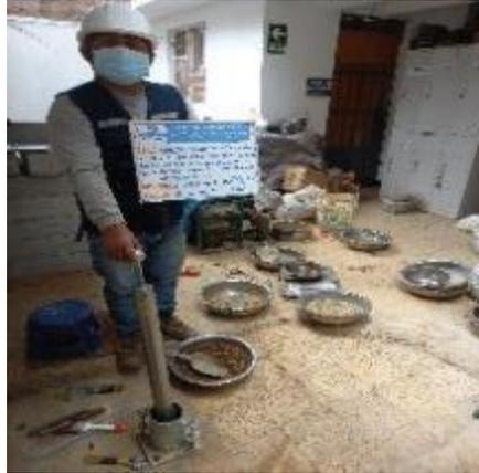
Se continuo con el mismo procedimiento de las anteriores calicatas, se utilizaron 4 moldes (4 puntos) 2 puntos secos y 2 puntos húmedos. Para cada molde se pesó 2093 gramos de suelo seco más 207 gramos de cemento (9% de 2300g) y se agregó los porcentajes de agua de forma consecutiva (9%,12%,15% y 18%)
