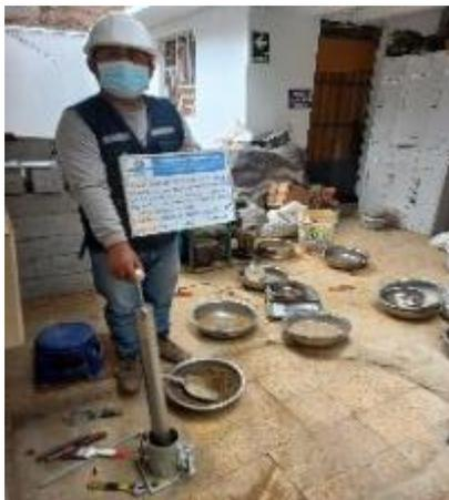
Ensayo Proctor modificado procedimiento A
