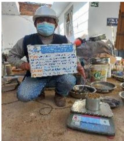
Ensayo Proctor modificado procedimiento A
