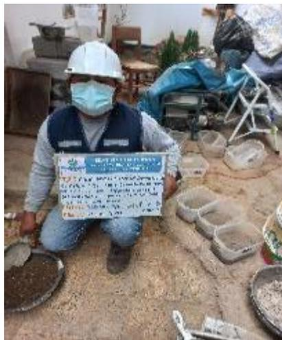
Ensayo Proctor modificado procedimiento A
