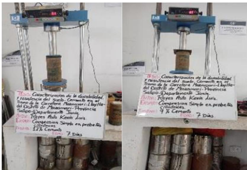
*Nota:* Ensayo compresión simple de probetas suelo cemento, Fuente: Elaboración propia ,2022
