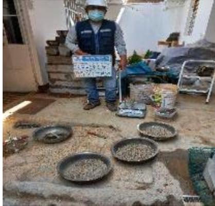
Ensayo Proctor modificado procedimiento A
