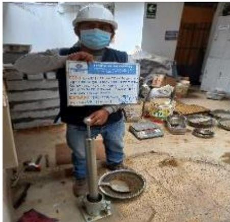
Ensayo Proctor modificado procedimiento A
