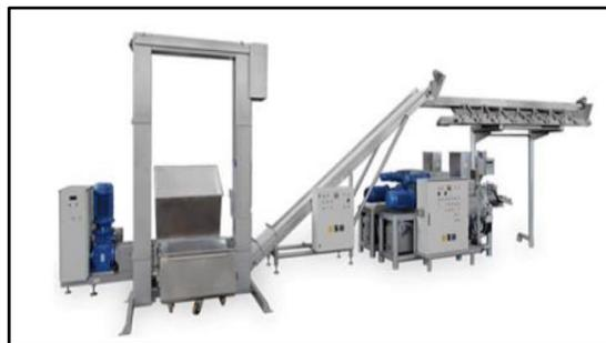
En esta máquina la pasta va a ir tomando la forma requerida para el molde final del chicle, quitándole los grumos que contiene la pasta de chicle gracias al mezclado.
