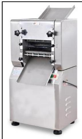
En esta máquina la goma base será cortada en un proceso continuo de acuerdo con las especificaciones requeridas por el operario. Obteniendo de esta manera bloques de goma base.
