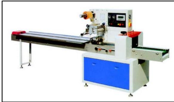
La función de esta máquina es empaquetar la unidad de chicle de manera progresiva y de esta manera estaríamos teniendo el chicle terminado.
