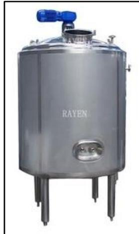
En esta máquina se hervirá la resina del árbol de zapote con el fin de obtener la goma base, el cuál tomará una forma sólida gracias a las hélices que el tanque posee.
