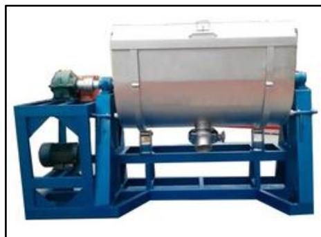
En esta máquina industrial se lleva a cabo el amasado de la goma base a través de una máquina de doble hélice utilizada para conseguir la formación de una masa homogénea.
