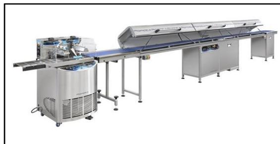
Debido a que la máquina extrusora bota una masa a altas temperaturas, se procede a pasar la pasta en el túnel de frío para bajar la temperatura a la que es requerida y de esta manera sea manejable la masa que será enviada al calibrador.
