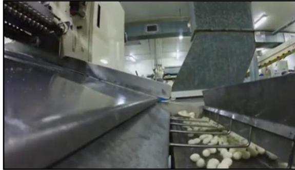
Esta máquina nos ayudara a bajar las temperaturas del chicle mediante el movimiento constante evitando a que este se pegue a cualquier tipo de máquina y pierda su forma original.
