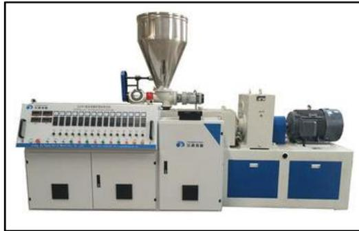
En esta máquina se utilizará el material pre extruido, donde será unificado mediante un juego de tornillos sin fin unificándolo en una misma masa para su posterior extrusión.
