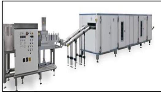
En esta máquina se utilizará el material pre extruido, donde será unificado mediante un juego de tornillos sin fin unificándolo en una misma masa para su posterior extrusión.
