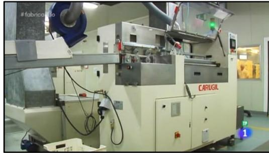
Esta máquina nos permite obtener tiras de un metro de masa para que al pasar a la máquina moldeadora – cortadora pueda obtenerse la forma del producto final.
