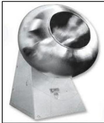
Esta máquina contiene un movimiento continuo que nos permite saborizar el chicle de manera uniforme, también nos permite tener el chicle a la temperatura correspondiente.
