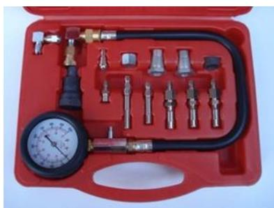
Figura 83. Manómetro de Compresión marca Eurotech.
