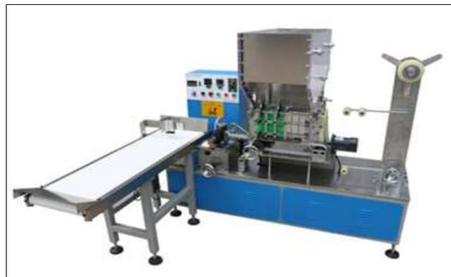
Figura 35. Máquina empacadora.
