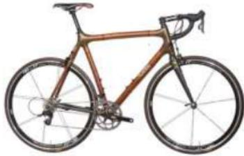
*Figura 11.* Bicicletas fabricadas con bambú. Adaptado de “Proyectos con Bambú” por Diario de Centro América, 2019.
