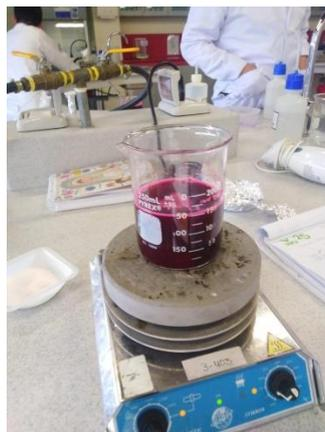
*Figura 26. Extracción sólido/solvente. / Fuente: Elaboración propia*
