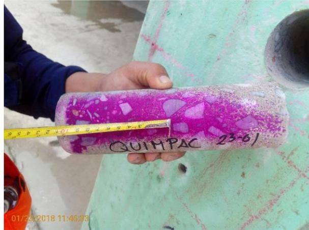
Figura 26: Medición de la carbonatación con el indicador de fenolftaleína. Fuente propia
