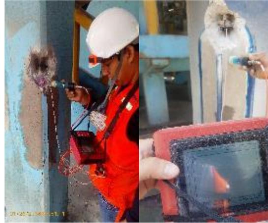
Figura 35: Medición del potencial eléctrico. Fuente propia
