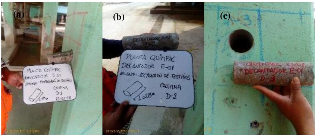
Figura 59: Registro fotográfico de la extracción de diamantinas (a) ECA 01- D1, (b) ECA 01- D2, (c) ECA 01- D3- Edificio Decantador E - 01 (ECA-01). Fuente propia
