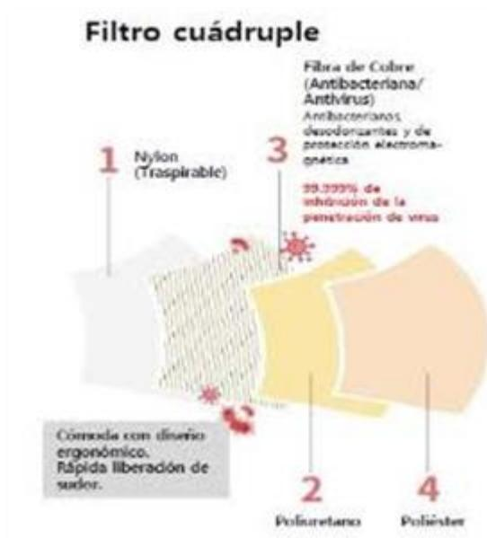
*Ilustración 41.* Composición de la mascarilla con microfibras de cobre.
