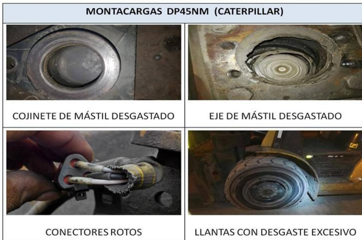
Fig. N° 21. Fallas y desgaste en Montacargas DP45NM.
