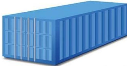
Tara: 2210 - 2400 Kg / Carga Máxima 21700 - 28240 Kg / Capacidad Cubica 33.3 m<sup>3</sup>
