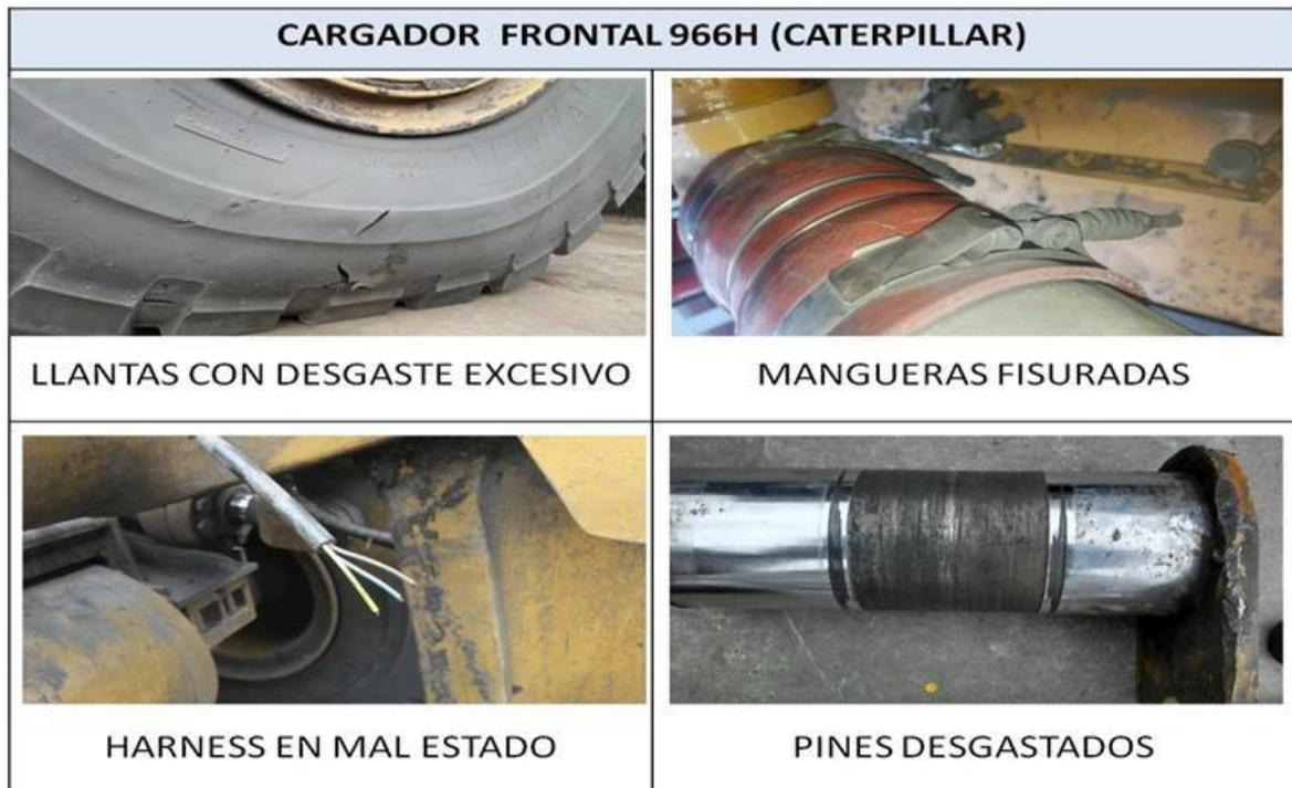
Fig. N° 19. Fallas y desgaste en Cargadores Frontales 966H.
