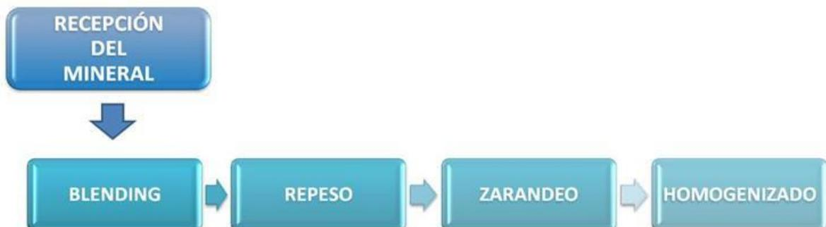
Fig. N° 11. Diagrama del proceso previo al almacenaje de minerales de PERUBAR S.A.
