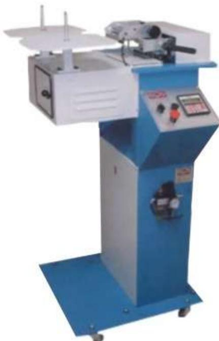
Máquina para colocar/recortar elásticos, velcro, zipper, tiras y fibras sintéticas.
