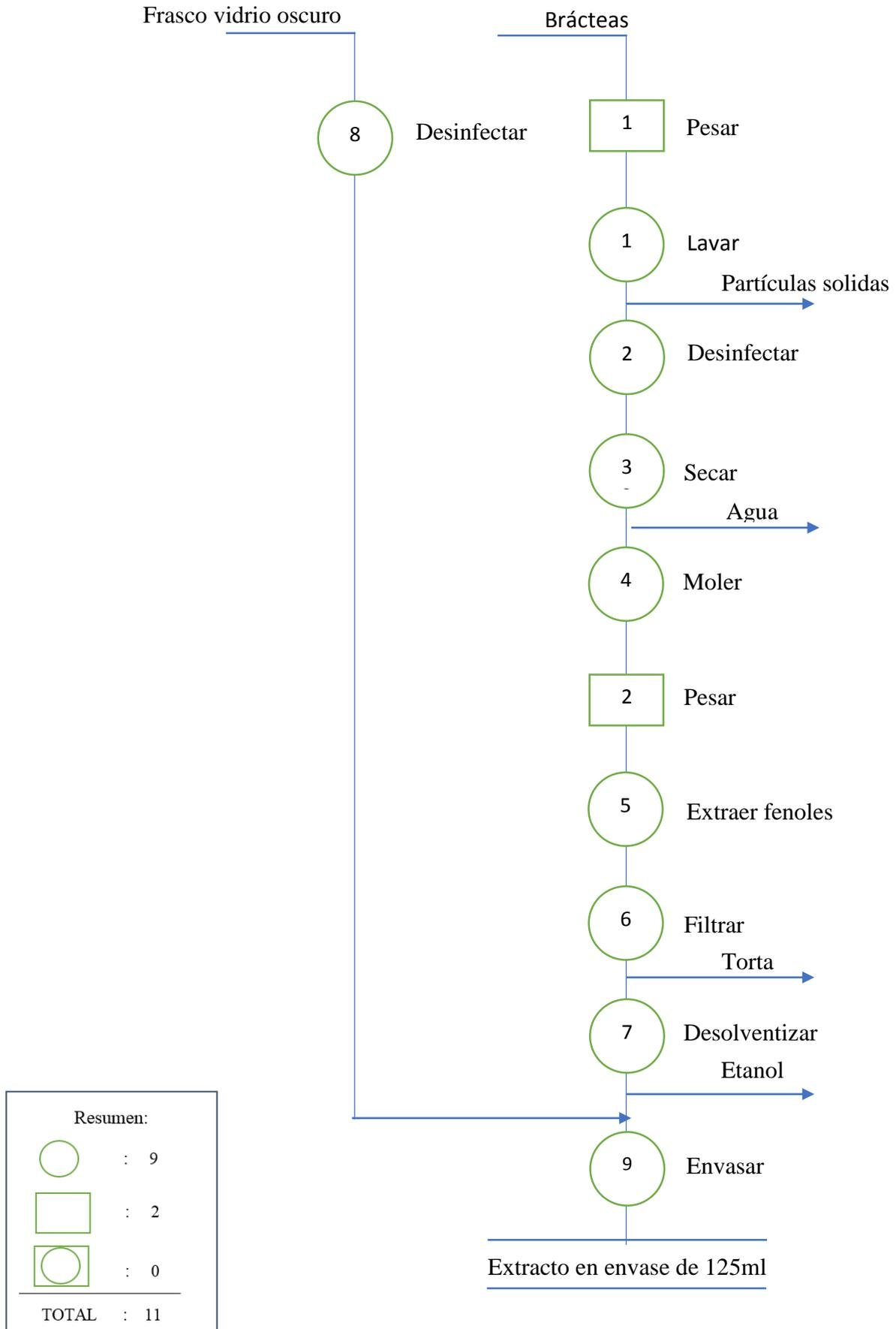
Figura 22.DOP de la obtención del extracto desolventizado
