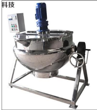
Figura 61. Máquina Paila auxiliar. Elaboración propia.
