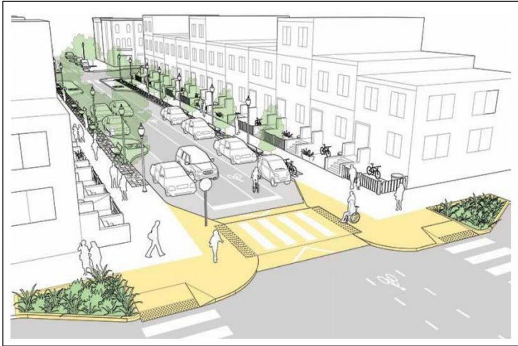
*Imagen 32. Infraestructura peatonal en una vía colectora / secundaria con cruces peatonales a nivel, orejas y reductor de velocidad.*
