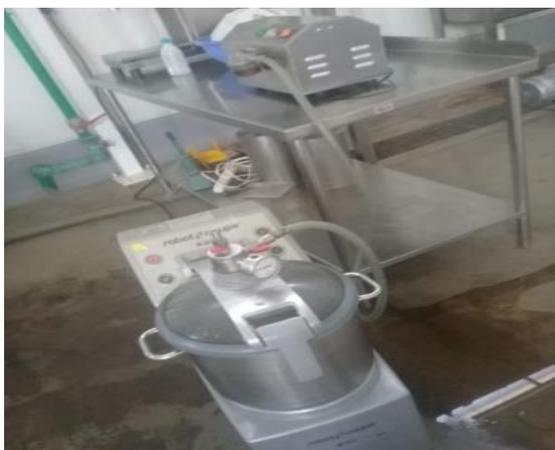
*Figura 12.* Pulpeado al vacío con robot coupe
