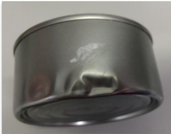
Fig. 7. Abolladura Fuerte (Grado 3)
