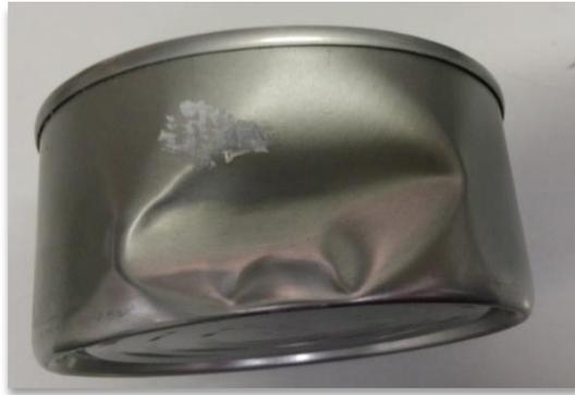
Fig. 6. Abolladura Fuerte (Grado 3)
