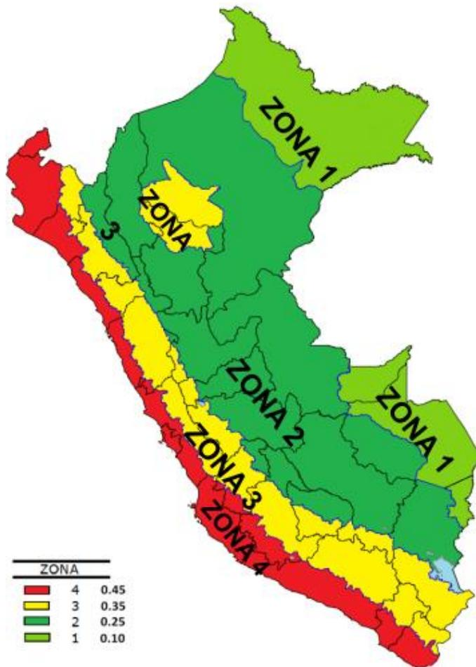
*Nota:* Mapa de Zonificación Sísmica, Adaptado de Lugo, Y. (2016). Norma E.030 Diseño Sismoresistente [Diapositiva de PowerPoint]. Ministerio de Vivienda, Construcción y Saneamiento. <http://www3.vivienda.gob.pe/dnc/archivos/SeminarioN/2.%20Norma%20E.030%20Dise%C3%B1o%20Sismorresistente.pdf>
