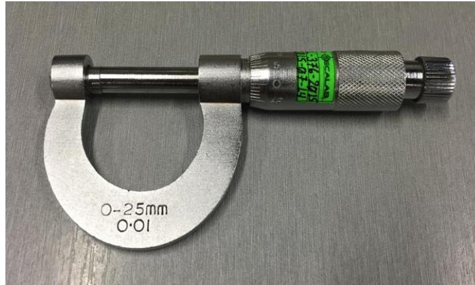
Micrómetro Utilizado para Determinar Espesor de los Empaques Utilizados.
