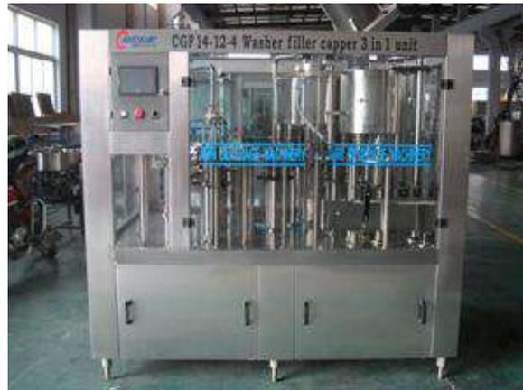
*Figura 12.* Llenadora para bebidas carbonatadas
