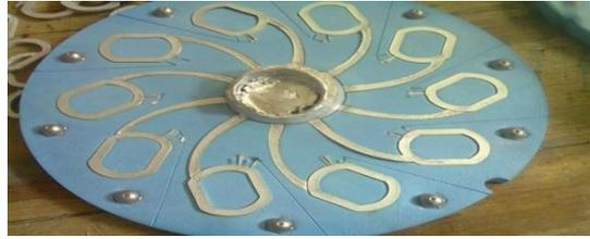
*Figura 10.* Moldes para fundición.
