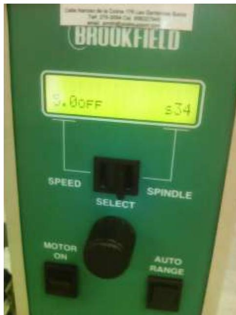
**Figura 43: Viscosímetro Rotacional Brookfield**
