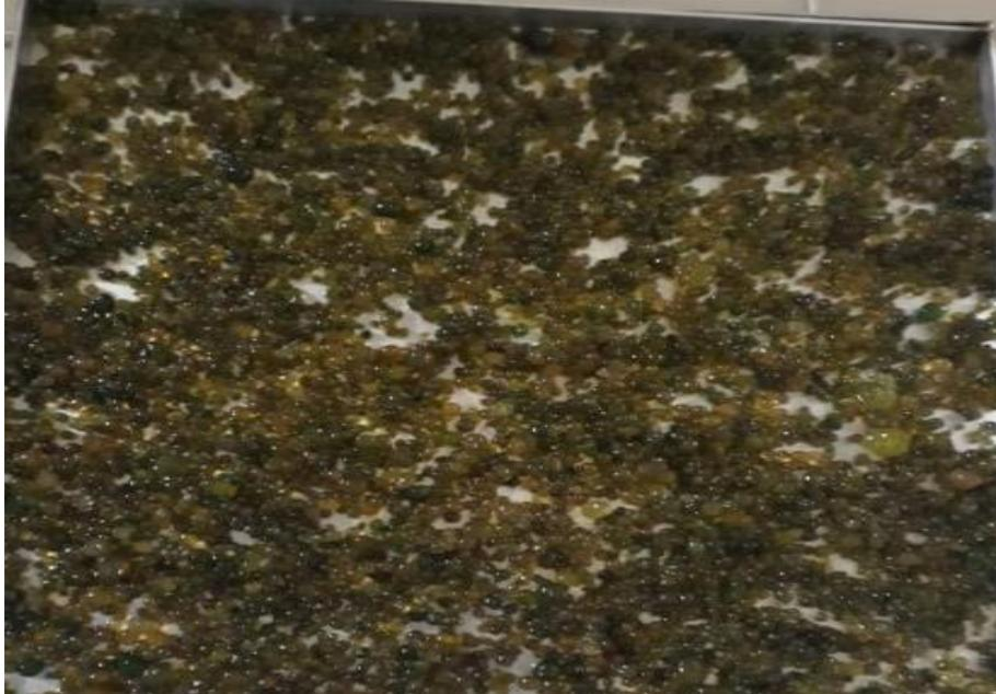
**Anexo 2:** Muestra seca en un secador de bandejas a 70°C
