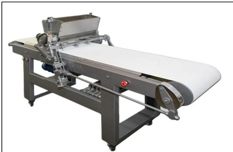
*Figura 57.* Galletera industrial. Adaptado de Maquipan, 2020.
