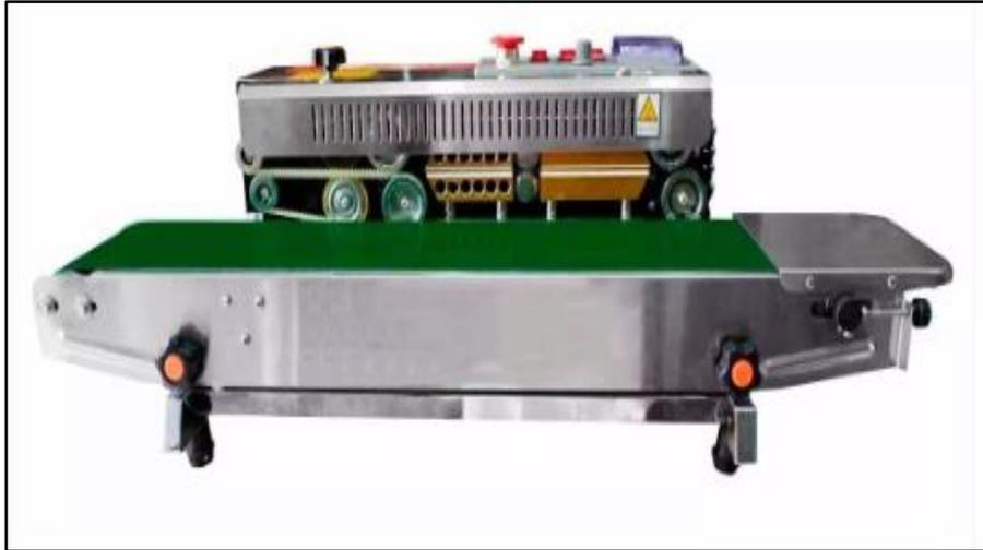
*Figura 58.* Selladora continua. Adaptado de Maqorito, 2020.
