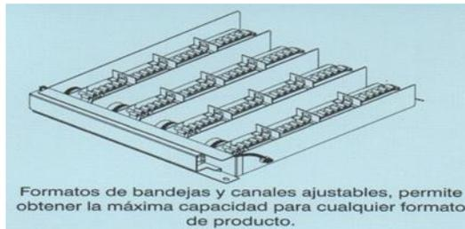
*Ilustración 21:* Formato de bandejas de la máquina Expendedora.
