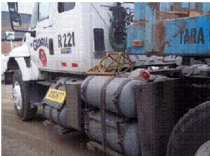
Figura 19. Camión de Raciemsa convertido a GNV.
