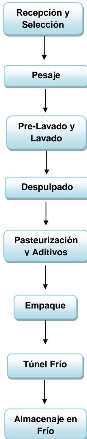
Figura 43. Diagrama de Flujo de Proceso
