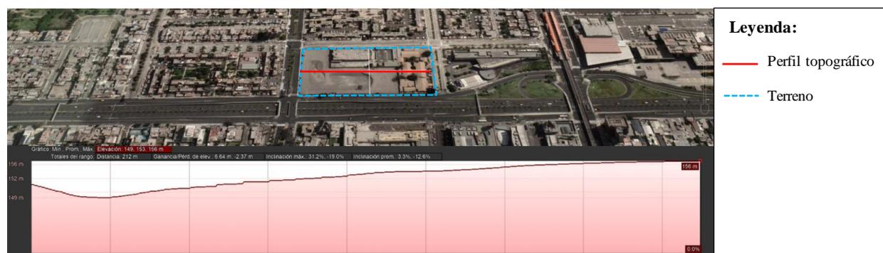
*Nota: Perfil topográfico longitudinal del terreno. Adaptado de "herramienta Global Mapper", por Google Earth, 2020.*
