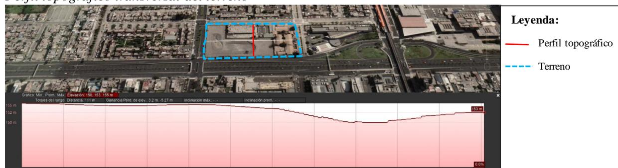
*Nota: Perfil topográfico transversal del terreno. Adaptado de "herramienta Global Mapper", por Google Earth, 2020.*
