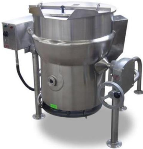
La marmita es una olla industrial cubierta con una tapa, cual queda totalmente ajustada y sirve para procesar alimentos nutritivos en grandes volúmenes y en la industria del procesamiento de alimentos se utiliza para efectuar diferentes procesos en los que se involucren transferencias de calor de forma indirecta.
