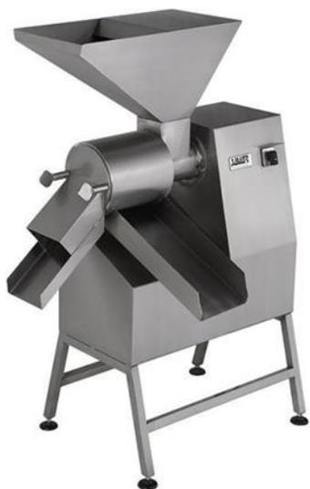
La despulpadora sirve para la extracción de la pulpa de las frutas, vegetales y hortalizas, cual luego se logra la separación de la pulpa de los demás residuos como en este caso son las pepas y la cáscara de papaya.
