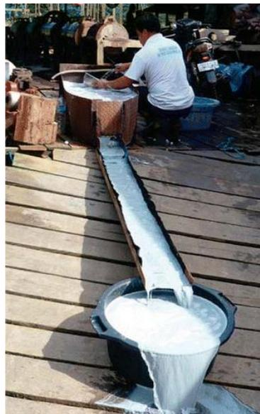
Figura 09. Canaleta y tolva cubierta de fieltro. Fuente: “Mercury-free gold extraction using borax for small-scale gold miners” por
