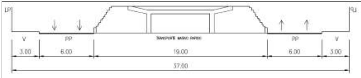
Figura 42: Sección actual de la Av. Aviación.
