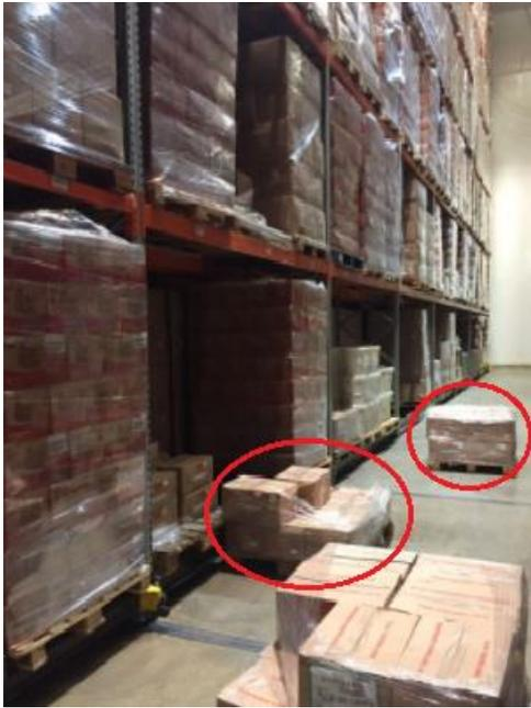
3. Palets con cajas en medio de los pasadizos, los cuales debe de estar en los racks y no impidiendo el paso del montacargas y de los trabajadores.
